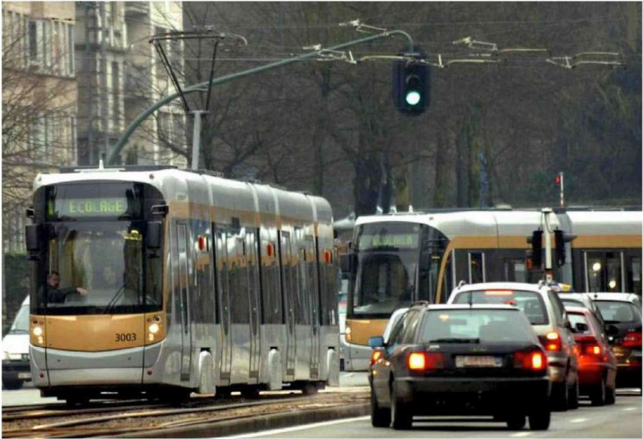
Accoupler deux T3000 sur la ligne 3 permettrait d'augmenter la capacité de 22 % en heure de pointe. © BELGA.
